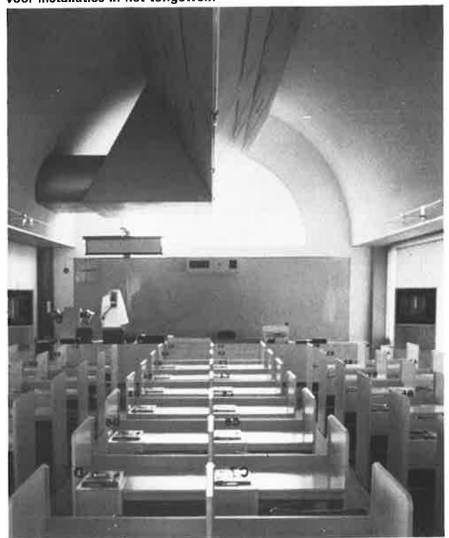
Audiovisueel centrum Oita. Talenpracticumzaal met driehoekige koker voor installaties in het tongewelf.
